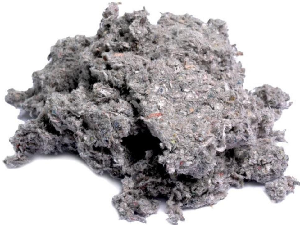
Zellulose-Einblasdämmung wird aus Papier hergestellt und gehört zu den natürlichen Dämmstoffen. Sie eignet sich zur Dämmung von Decke, Wand und Dach. Foto: FNR/W. Freese
