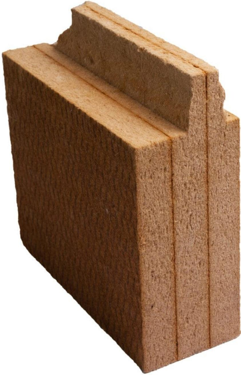
Holzweichfaserplatten kommen häufig als Dachdämmung zum Einsatz, weil sie einen besonders guten sommerlichen Wärmeschutz gewährleisten. Foto: FNR/W. Freese
