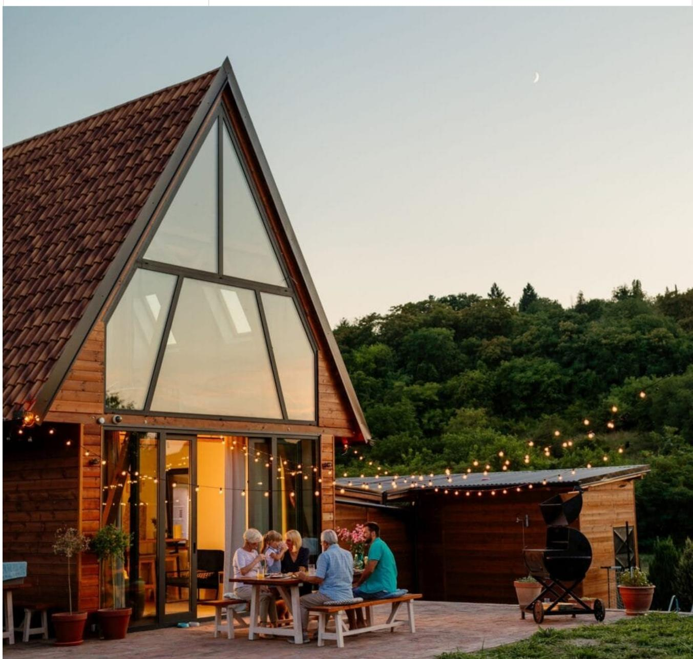
Die Glasfassade dieser Pfosten-Riegel-Konstruktion bringt reichlich Tageslicht in das Innere des Hauses. Foto: bernardbodo/www.elements.envato.com
