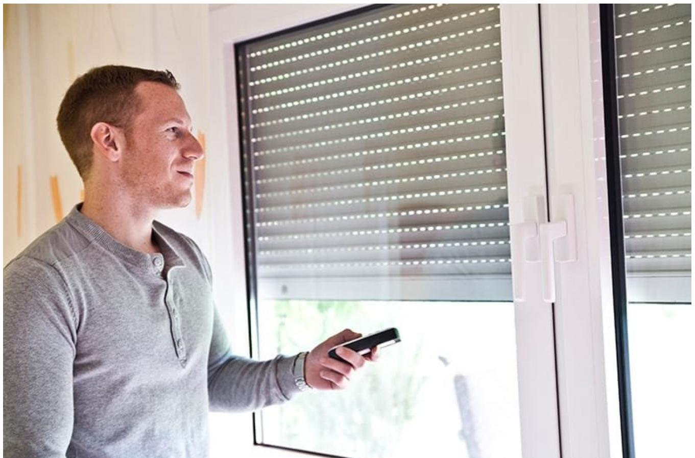
Das volle Kühlungspotenzial von außen liegendem Sonnenschutz kann durch eine Automatisierung von Rollläden, Raffstores oder Screens erzielt werden. Foto: BVRS e.V.
